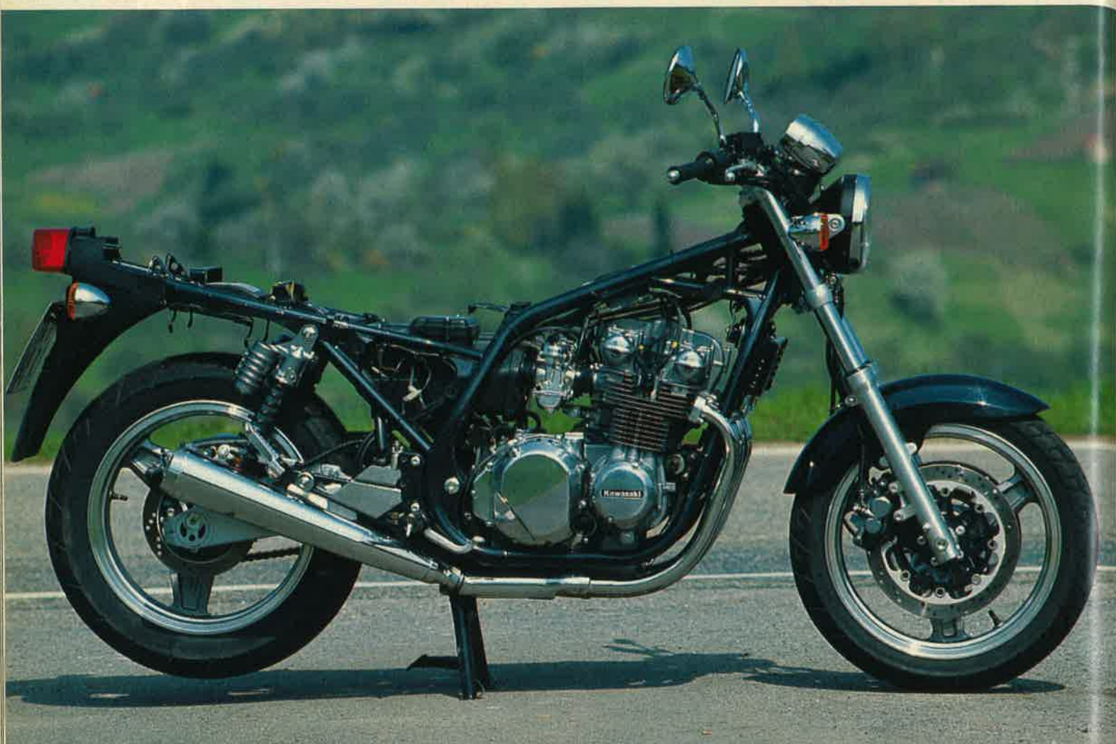
Zephyr: großzügig dimensionierter Stahlrohrrahmen. Die Streben am Lenkkopf erhöhen noch die Stabilität
