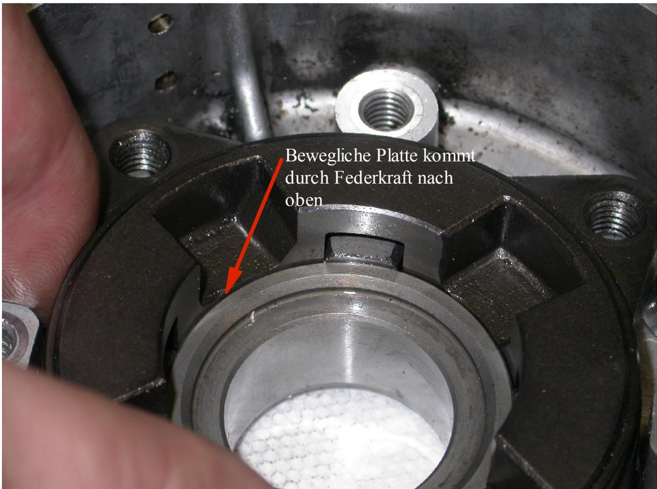
*Abbildung 21: Bewegliche Platte hoch, Schiebetrieb*
