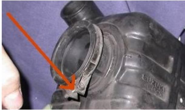
*Abbildung 4: Schelle des Gummihutzens am hinteren Luftfilterkasten*
