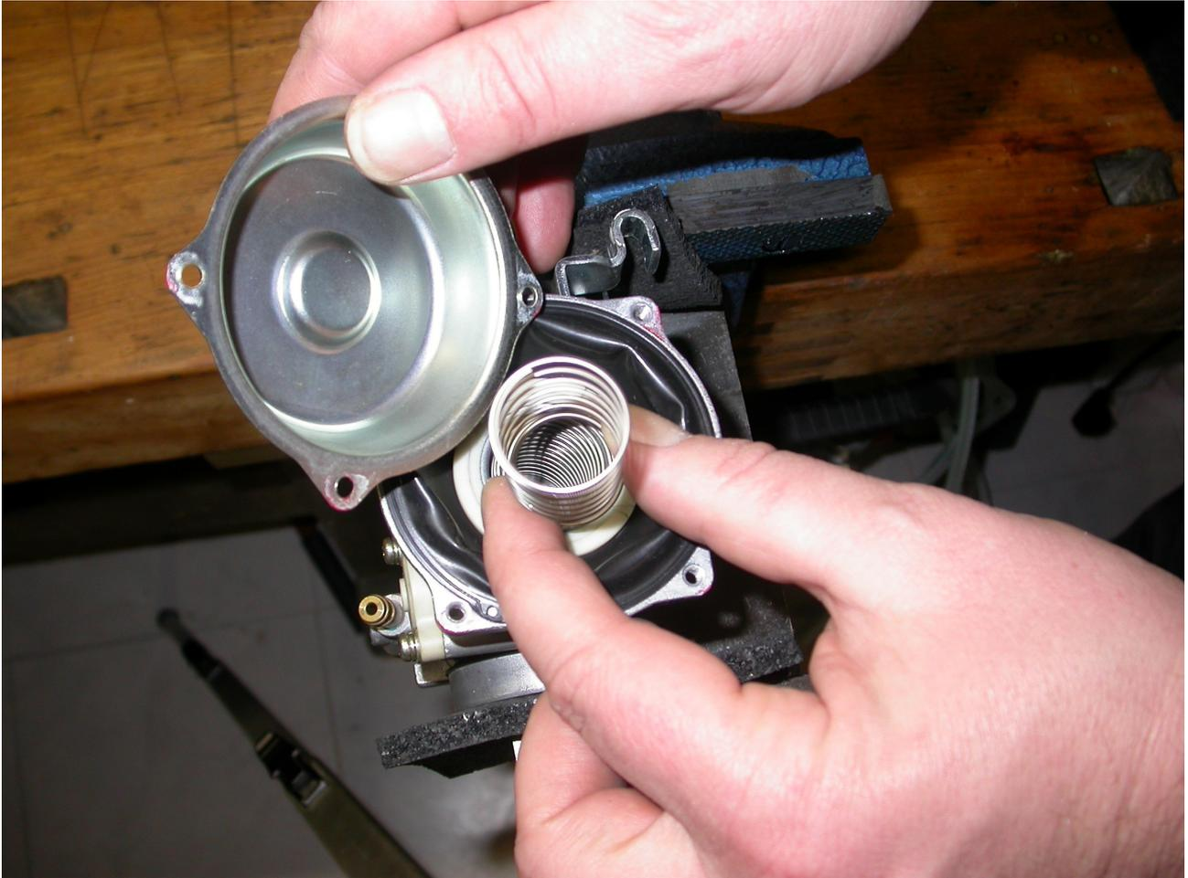
*Abbildung 69: Schieberfeder einsetzen und Deckel montieren*
