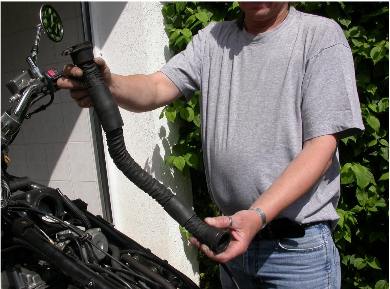
*Abbildung 1: Luftfilterschlauch*
