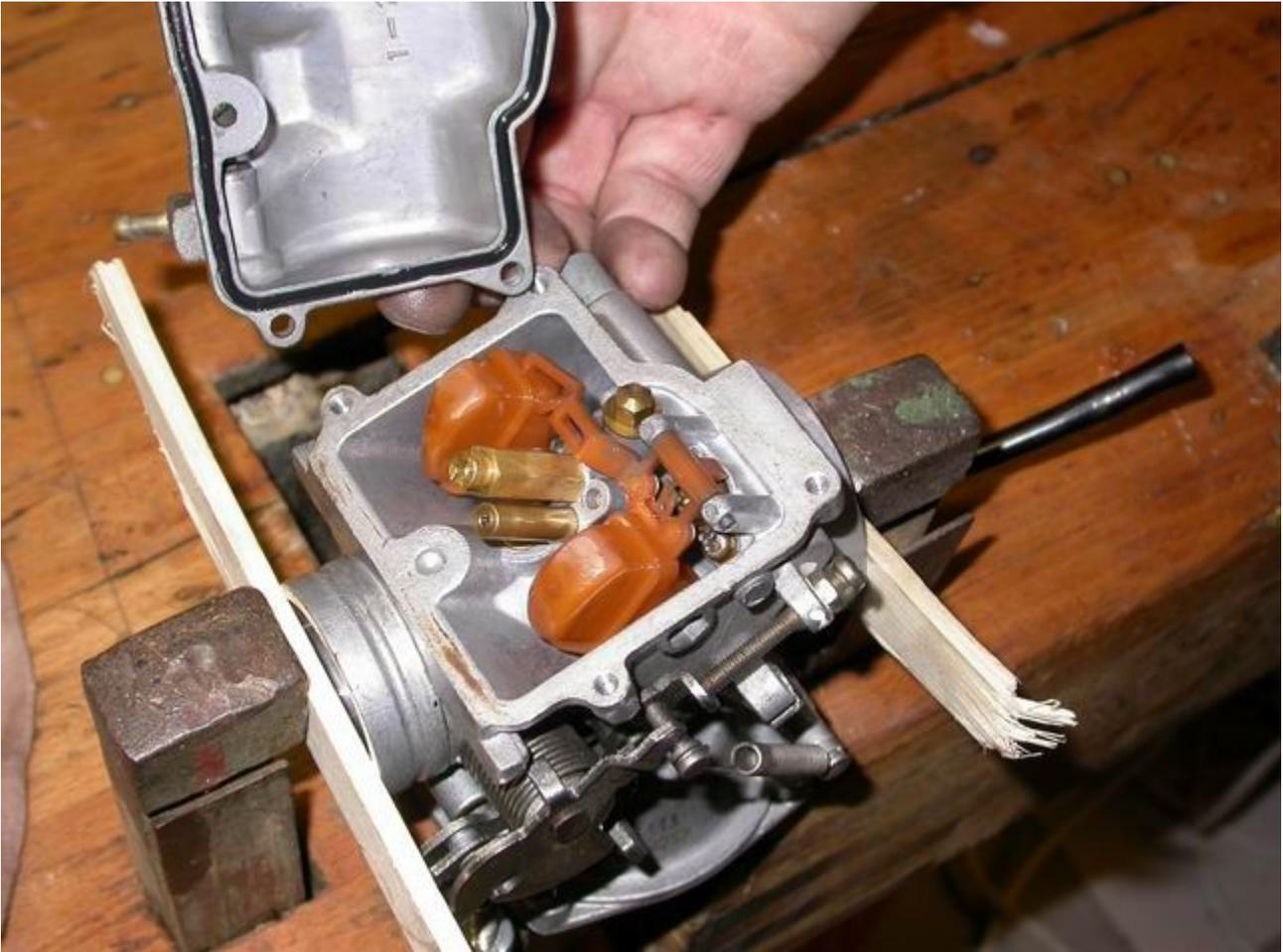
*Abbildung 24: Schwimmerkammerdeckel geöffnet*
