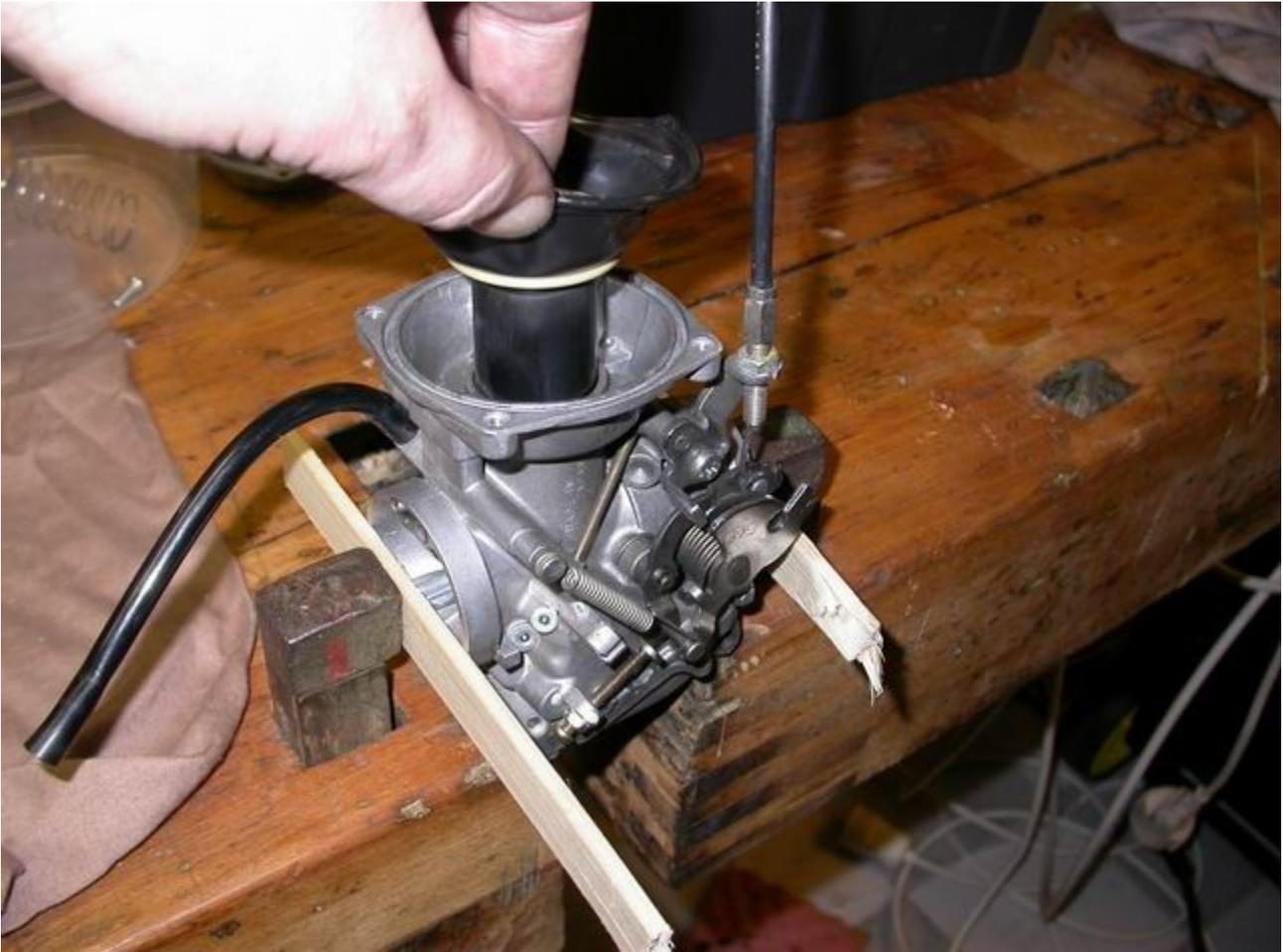
*Abbildung 21: Vergaserschieber nach oben herausziehen*
