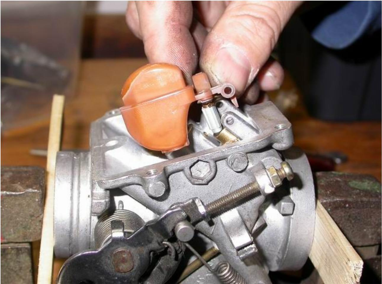
*Abbildung 36: Schwimmer zusammen mit der Ventalnadel einführen.*
