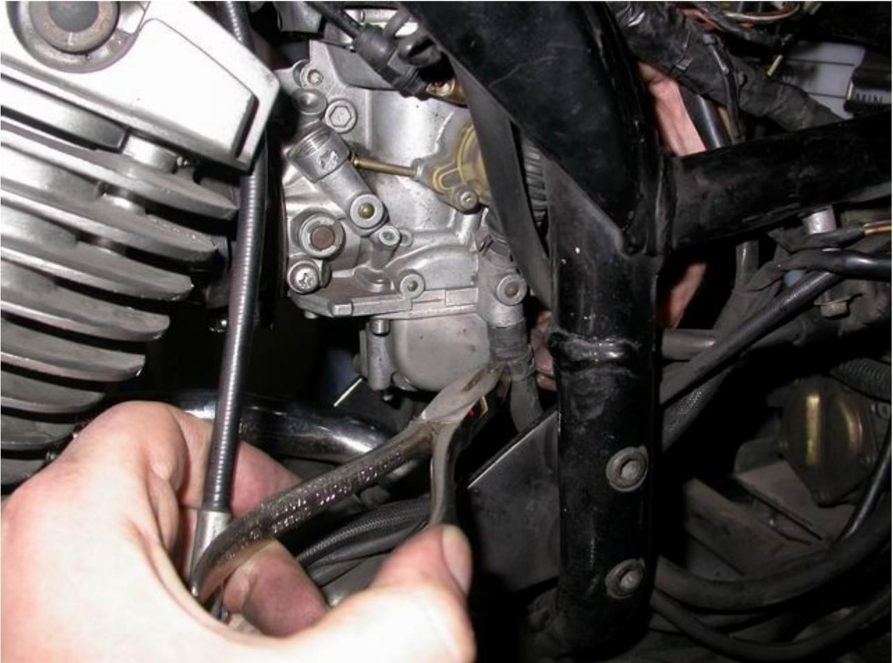
*Abbildung 15: Halteklammer des Benzinschlauchs zusammendrücken und nach unten schieben.*
