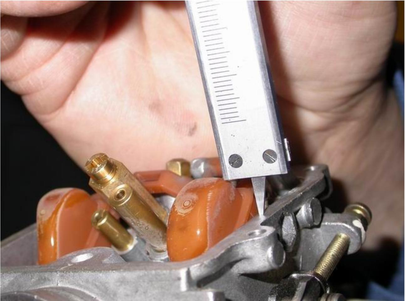
*Abbildung 39: Flucht des Schwimmers mit der Schieblehre prüfen.*
