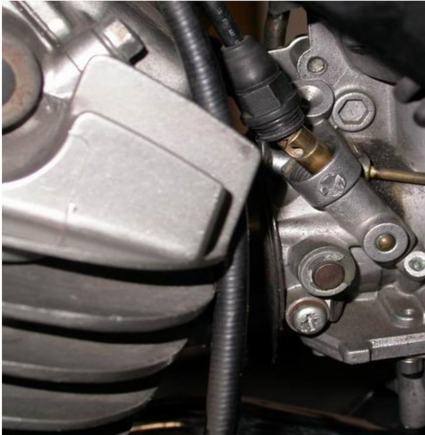
*Abbildung 14: Chokezug hinten, ausgeschraubt*
