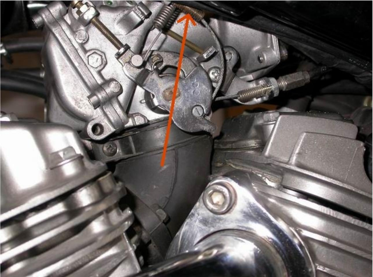
*Abbildung 10: Vollständig eingedrehte Einstellschraube des vorderen Gaszugs*
