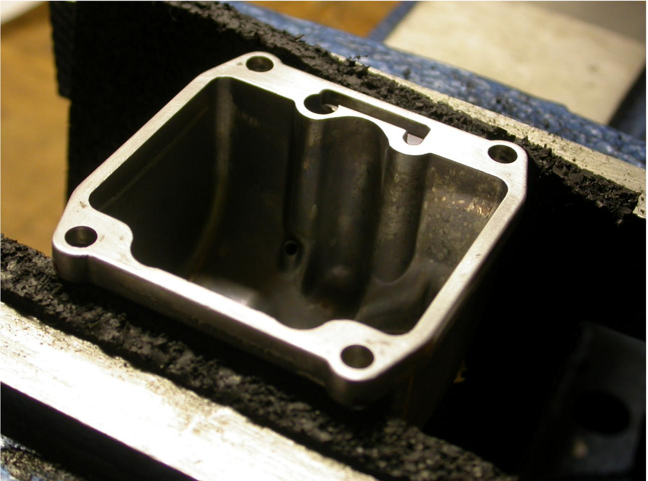
*Abbildung 65: Dichtfläche nach dem Putzen*
