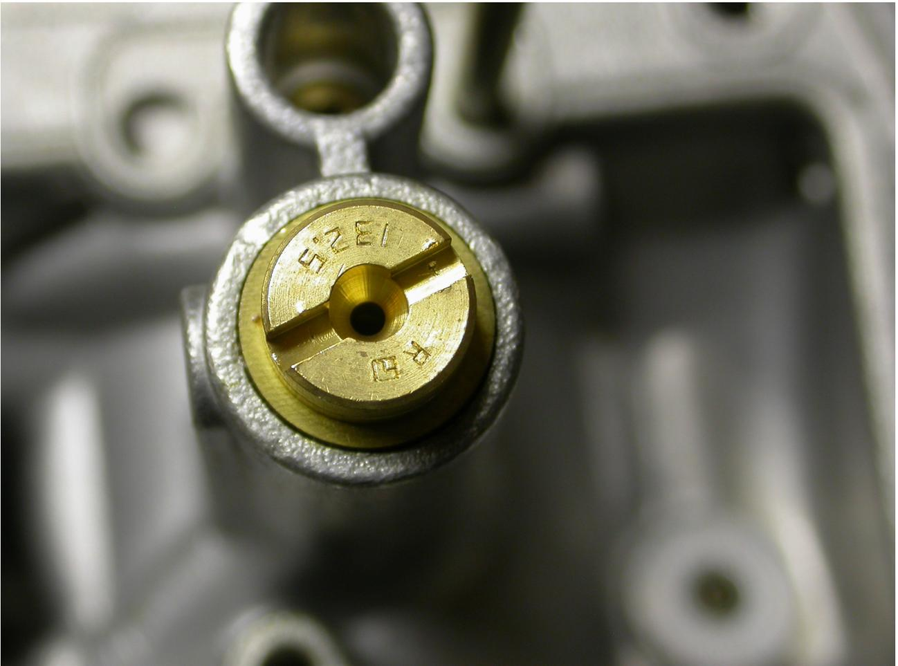
*Abbildung 51: Hauptdüse am hinteren Vergaser*
