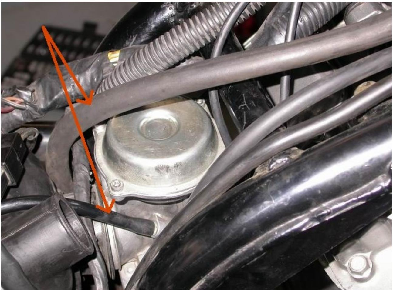
*Abbildung 5: Motorentlüftung und Vergaserüberlauf*
