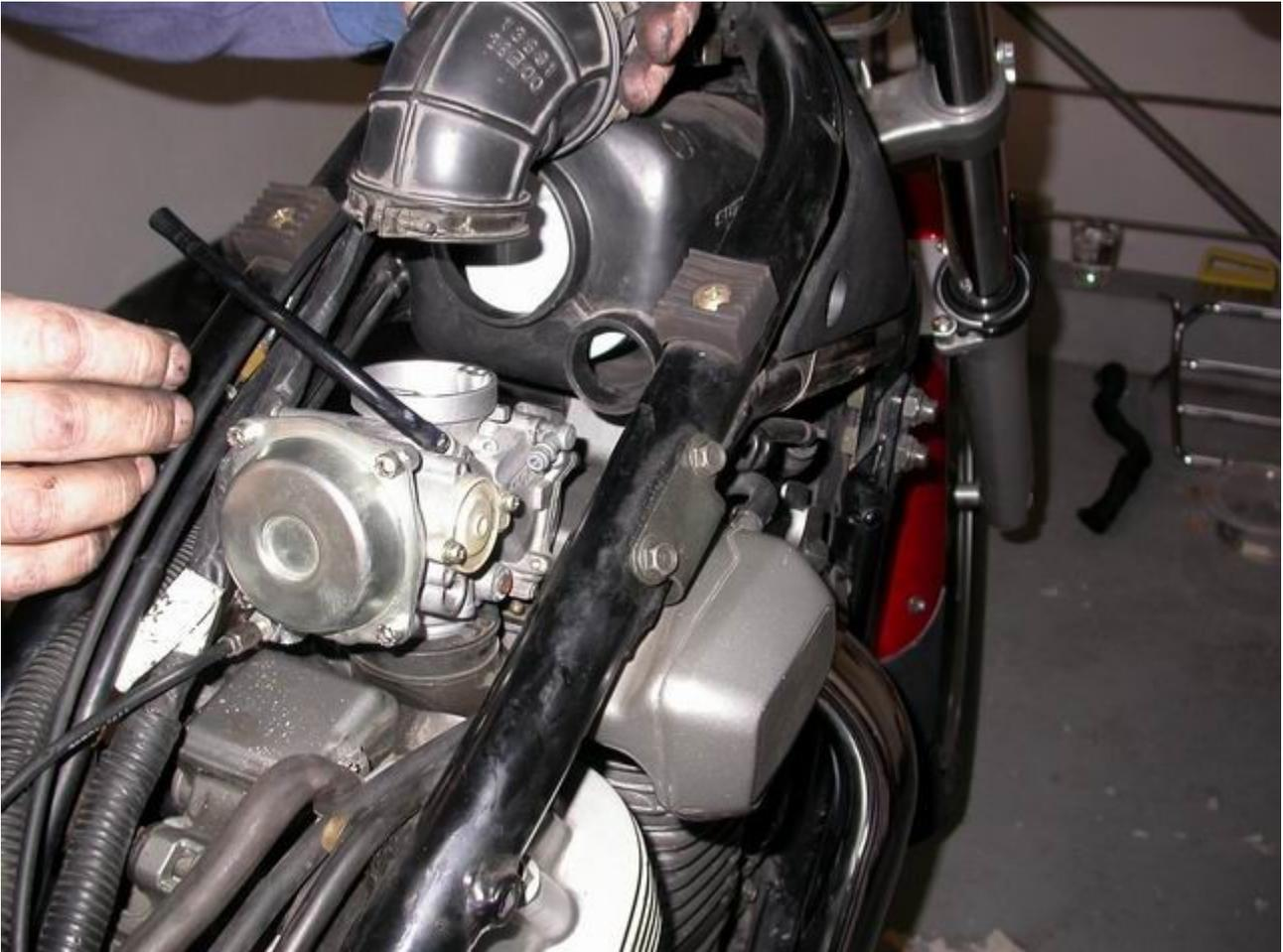
*Abbildung 17: Ansaugrohr am vorderen Vergaser abnehmen.*
