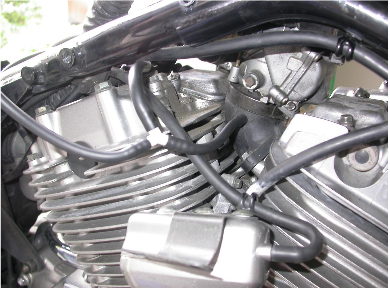
*Abbildung 84: Messuhr am vorderen Zylinder mit T-Stück anschließen*
