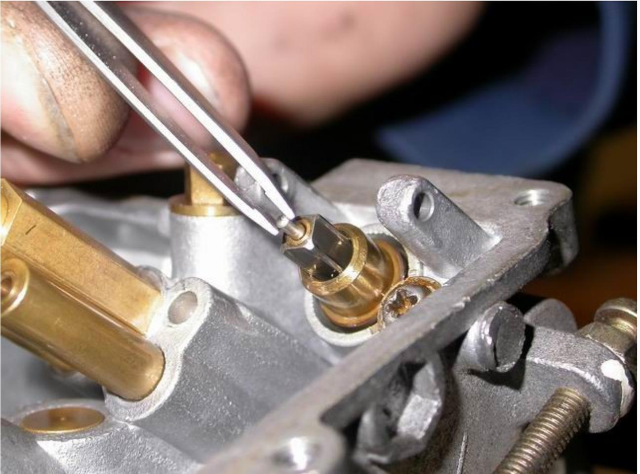
*Abbildung 28: Nadel aus dem Nadelventil ziehen*
