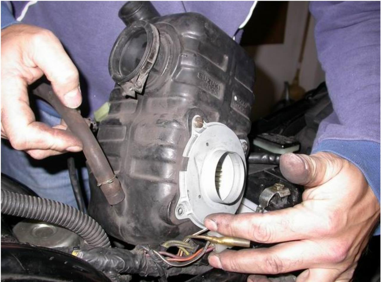
Abbildung 6: Hinterer Luftfilterkasten ausgebaut. Motorentlüftungsschlauch wieder aufgesteckt.
