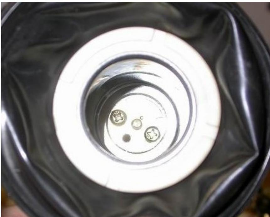
Abbildung 41: Blick in den korrekt montierten Schieber.
