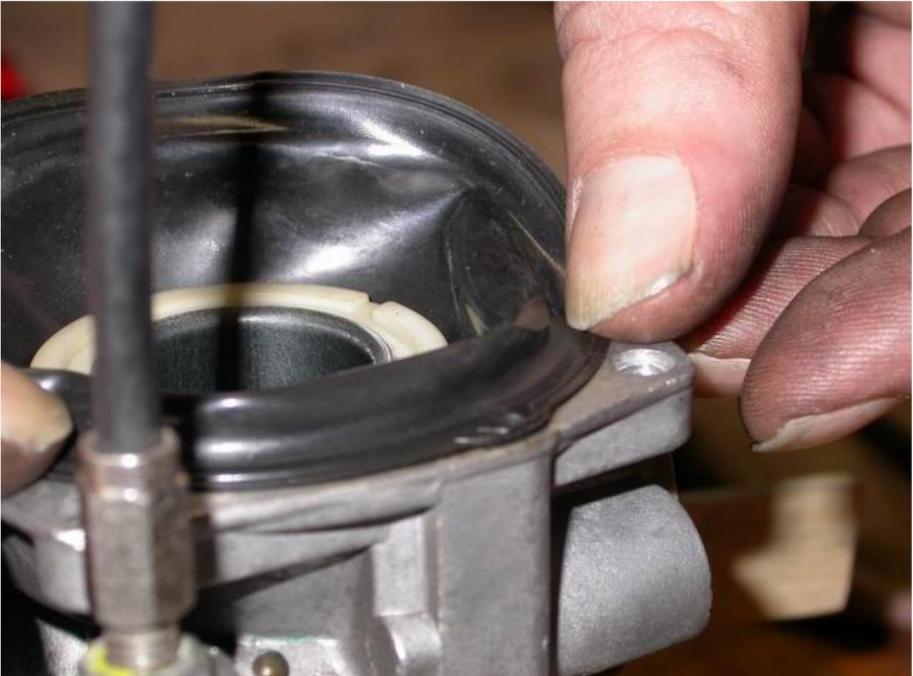
*Abbildung 43: Wulst der Membran in die Nut am Vergasergehäuse einlegen.*
