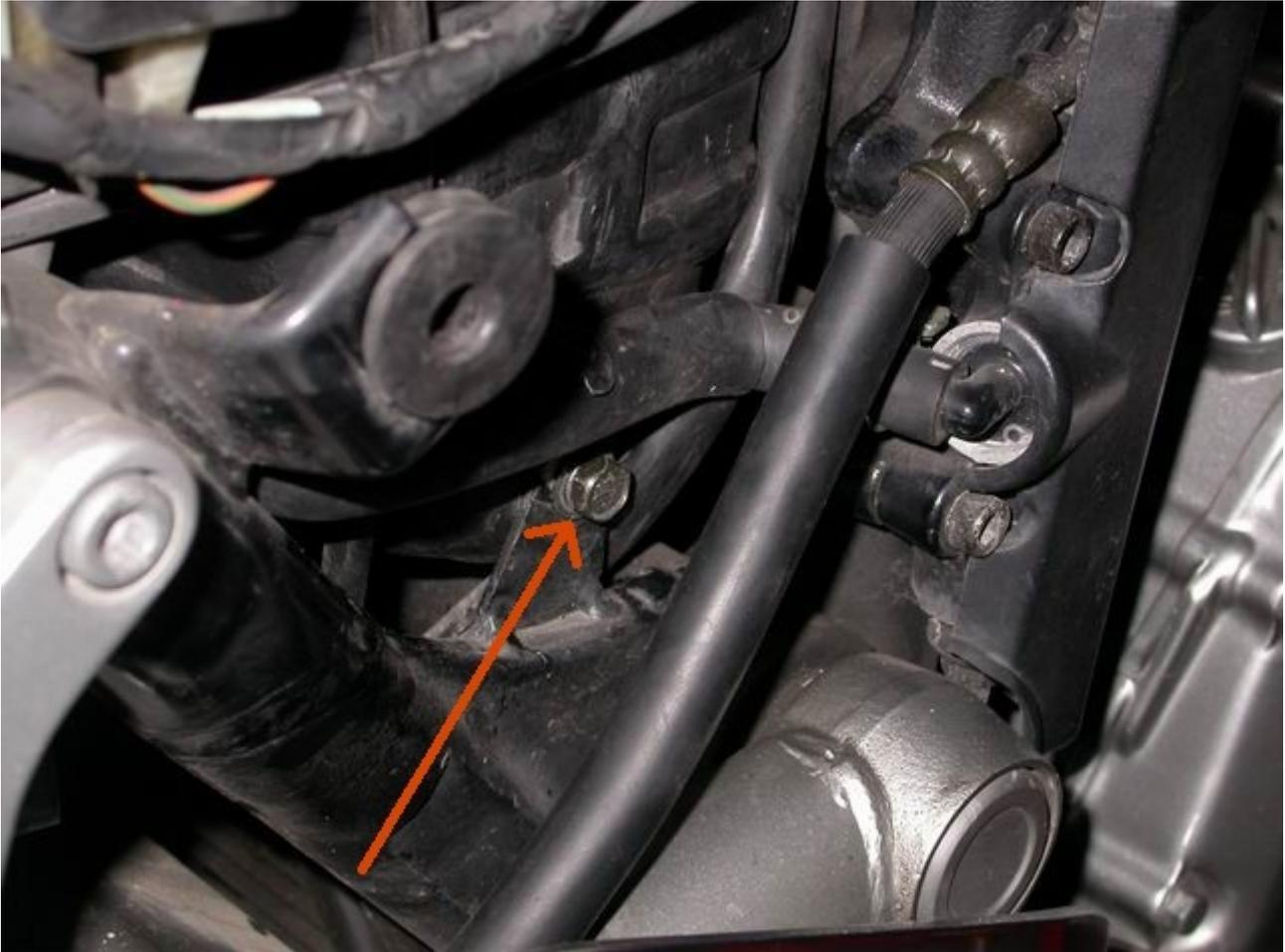
*Abbildung 3: Untere Schraube des hinteren Luftfilterkastens*
