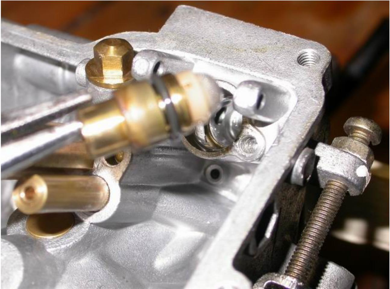
Abbildung 30: Nadelventilkörper herausziehen
