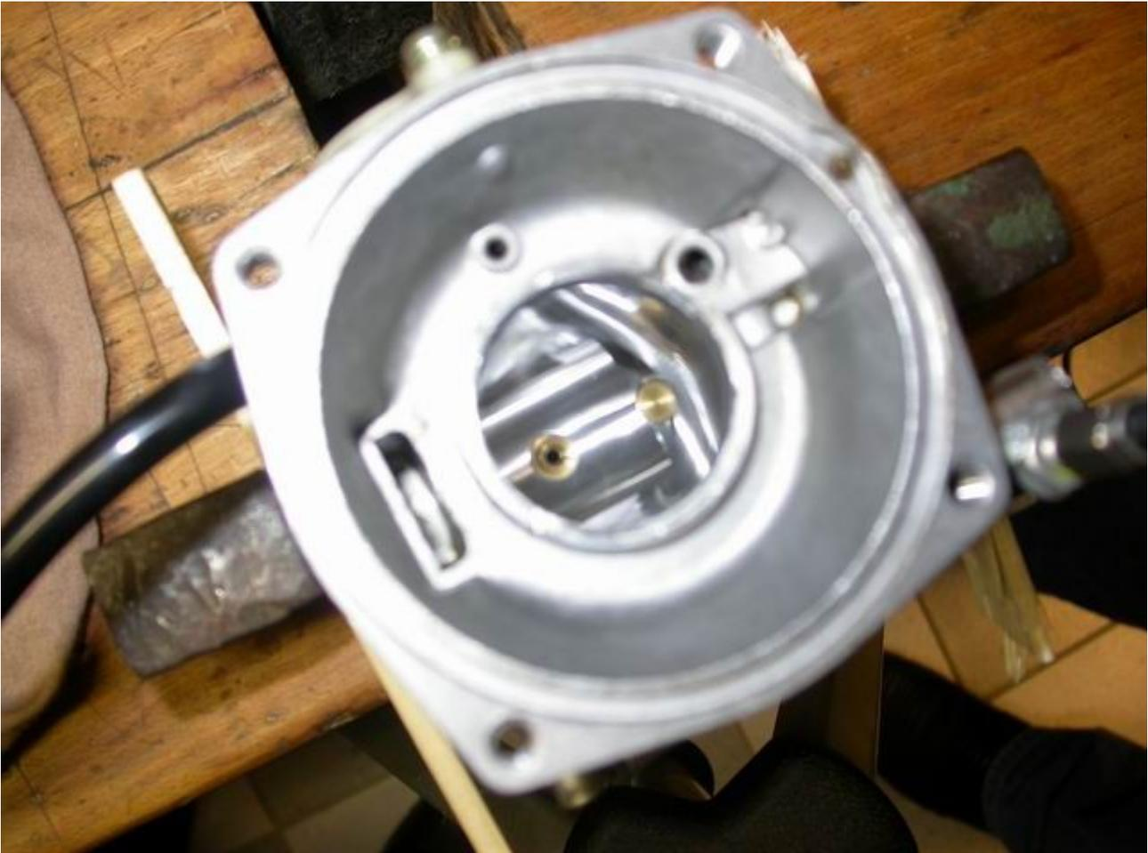
*Abbildung 22: Blick in den Zylinder des Vergaserschiebers*
