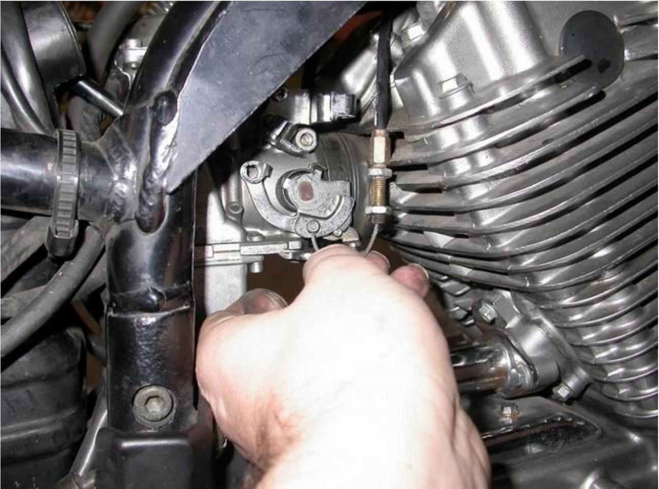
*Abbildung 9: Nippel des Gaszugs aus der Kulisse ausfädeln.*
