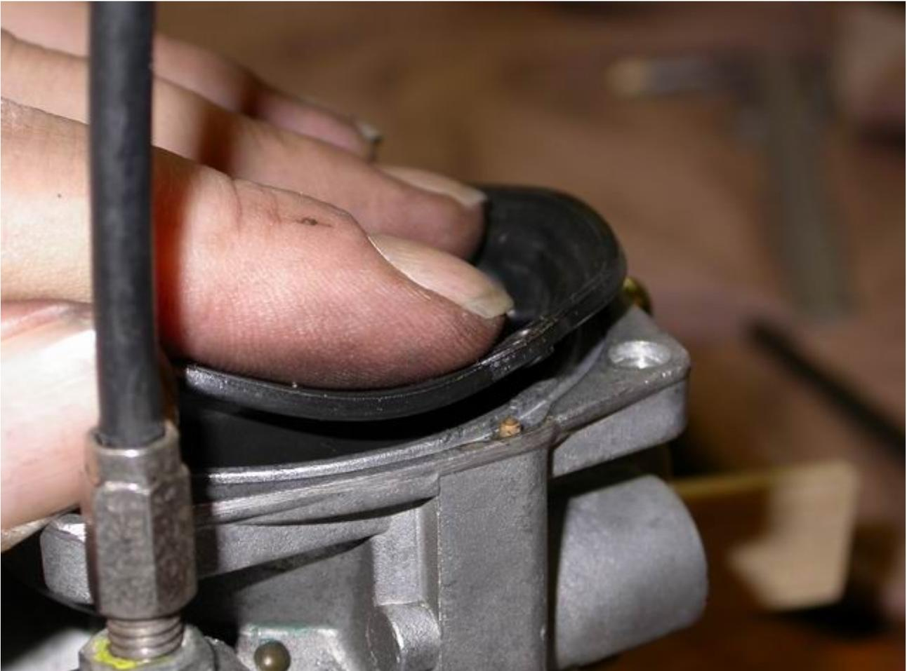
*Abbildung 42: Membran genau ausrichten.*
