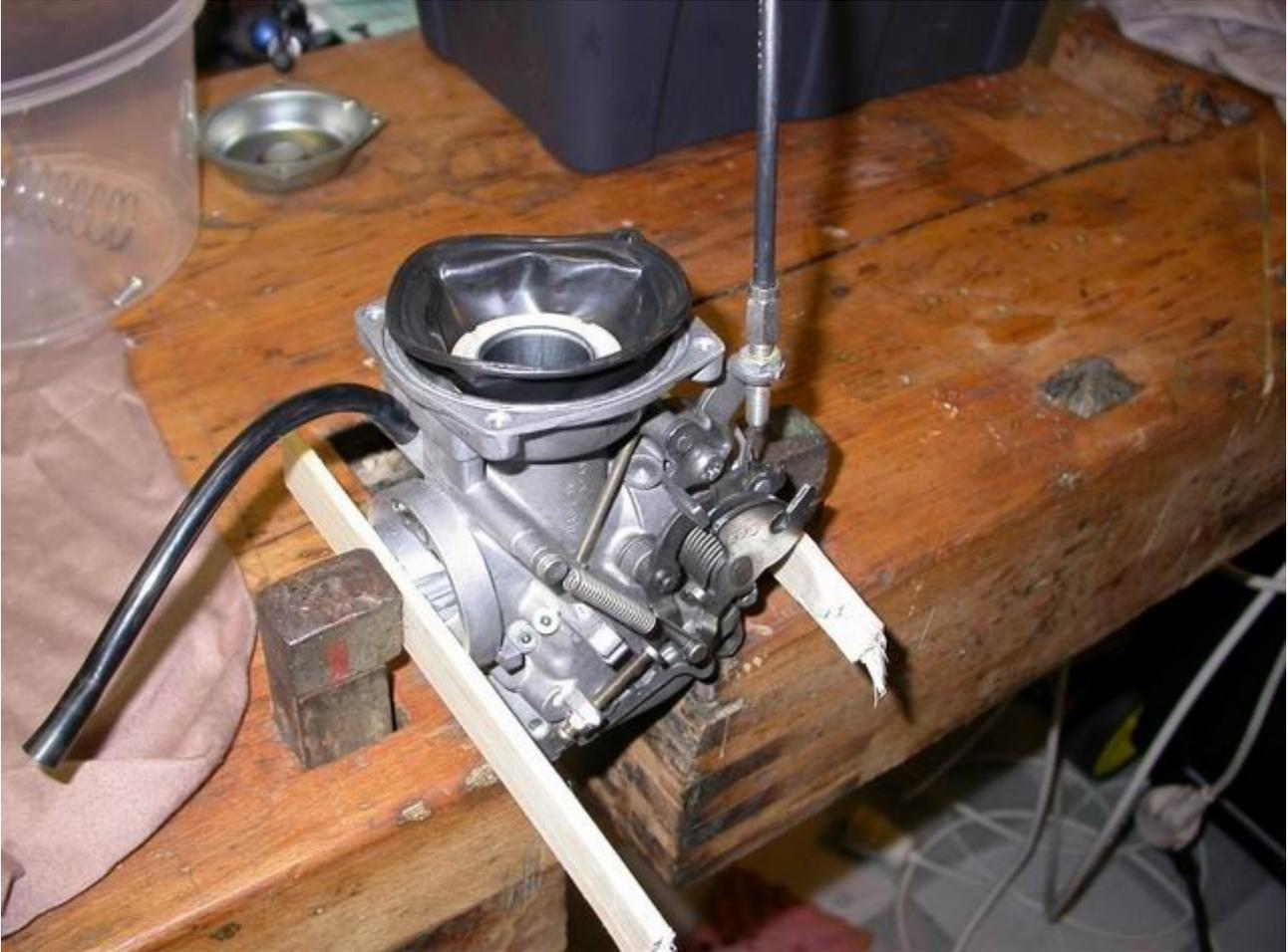
*Abbildung 20: Rundum herausgelöste Membran*
