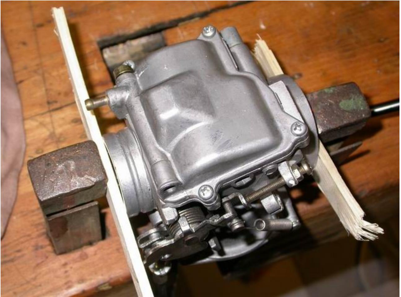
*Abbildung 23: Schwimmerkammerdeckel des vorderen Vergasers*
