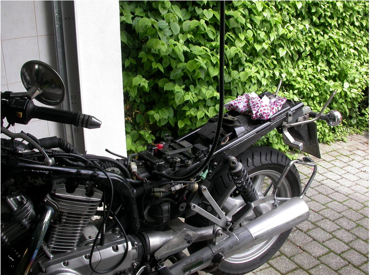
*Abbildung 83: Kraftstoffversorgung über Benzinflasche*
