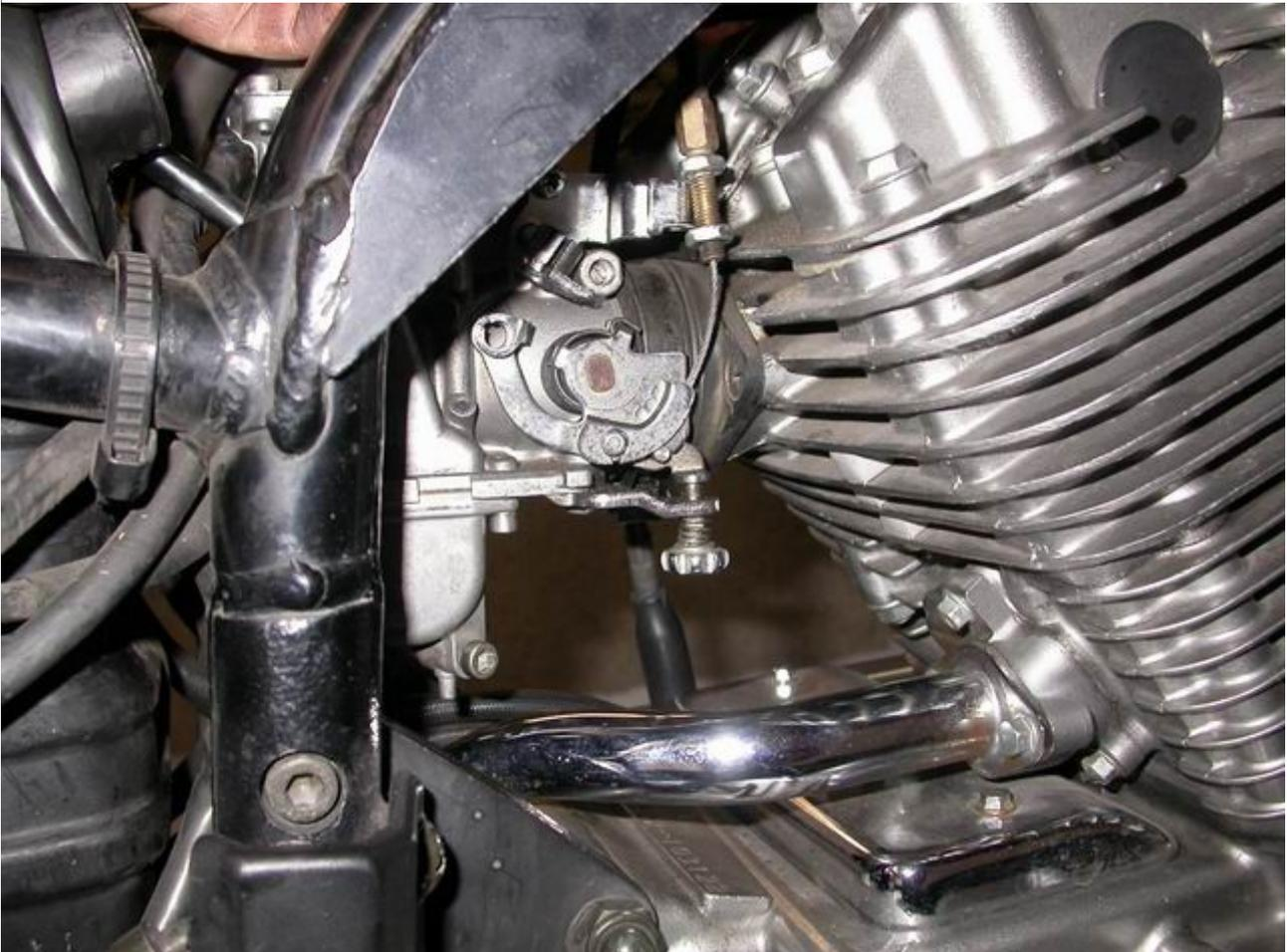
*Abbildung 8: Gaszugeinstellschraube aus der Halterung nehmen.*
