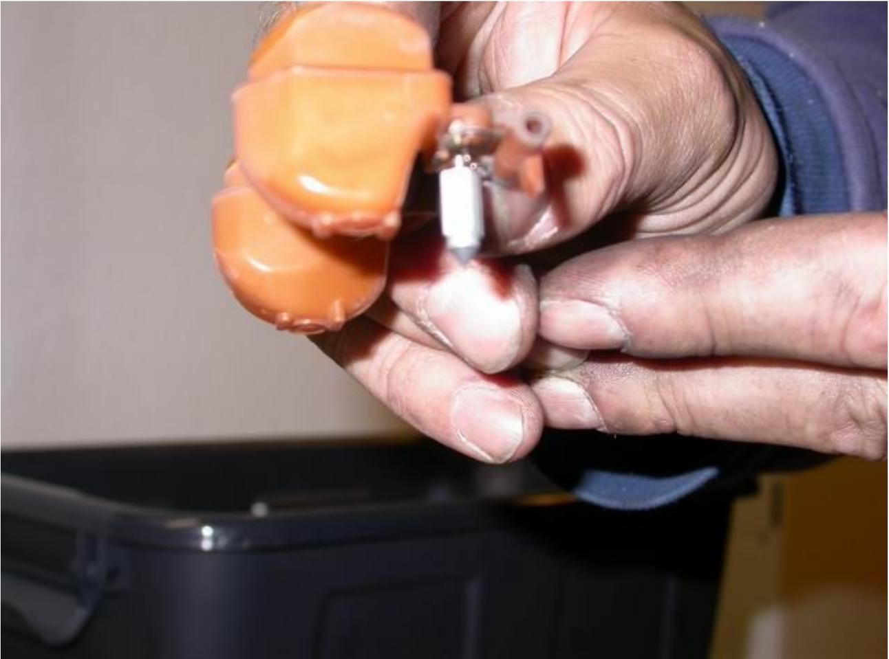
*Abbildung 27: Nadel mit Drahtbügel am Schwimmer eingehängt*
