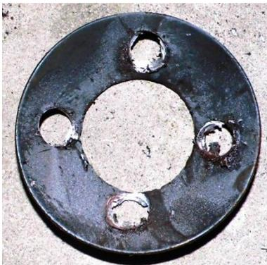
Der alte (vergammelte) Einsatz kann nur entfernt werden, indem man den kompletten Rand durchtrennt. Also auch hier ankörnen und einen Kreis von möglichst eng beieinander liegender Bohrungen (4mm) um den Einsatz zaubern.
