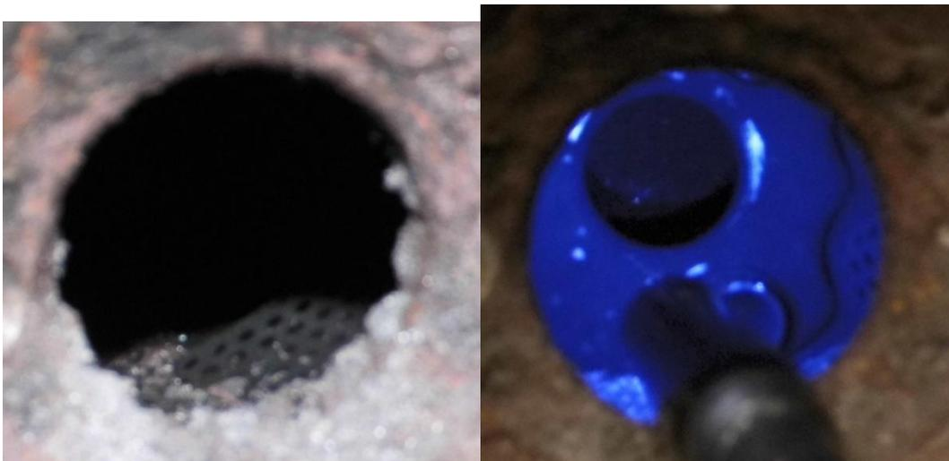
Die Öffnung nun mit der Rundfeile so erweitern, dass das Käfer-Endrohr hindurchpasst.
