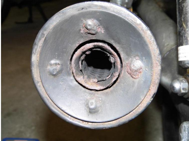
Die 4 Schweißpunkte müssen entfernt werden. Dazu die Punkte ankörnen und mit kleinem Bohrer ( 4mm ) vorbohren.
