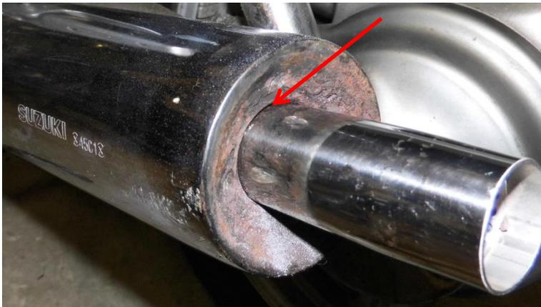
Dort muss das Endrohr abgesägt werden. Das verbleibende Stück ist gar nicht mehr so lang.
