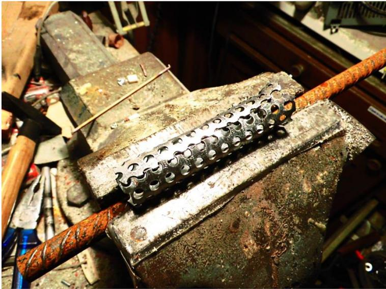
Das Hintere Ende wird aufgeweitet – deshalb auch die beiden Flügel.
