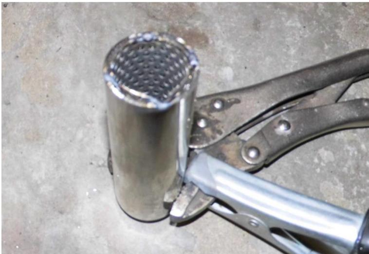
Nun könnte das Stück Endrohr eingeschoben und festgeschweißt werden. In den unteren Drehzahlbereichen ist die Lautstärke dadurch auch sehr schön gedämpft, aber oberhalb von 2.500 bis 3.000 Umdrehungen pro Minute fängt die gute VX damit an, einer Panigale Geräuschtechnisch Konkurrenz zu machen. Das passt einfach nicht zur VX und würde dem netten Herrn vom TÜV auch nicht gefallen.
