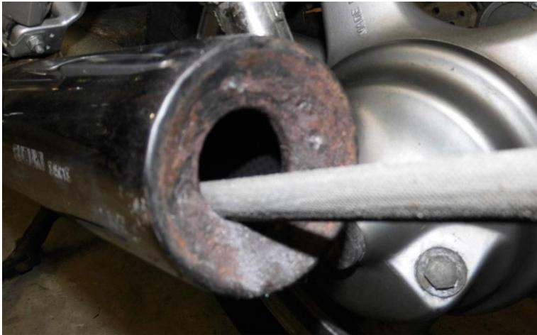
Das Endrohr verkehrt herum reinstecken, um die genaue Länge zu markieren ( mit einer Feile oder Stahlnadel anreißen ).
