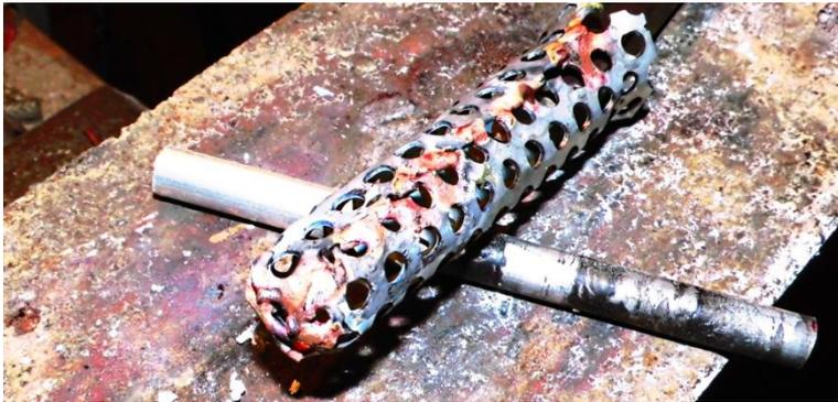
Ein Band aus dünnem Blech dient zur Dämpfung der hohen Frequenzen. Auch das wird mit Hartlot fixiert.
