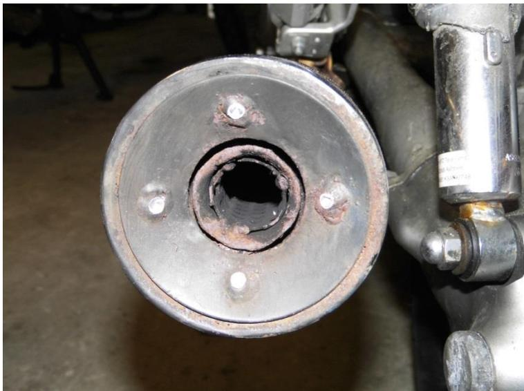
Anschließend mit 10 mm Aufbohren. Die Tiefe erkennt man daran, dass zwischen den Metallschichten eine leicht verfärbte Trennlinie erkennbar ist
