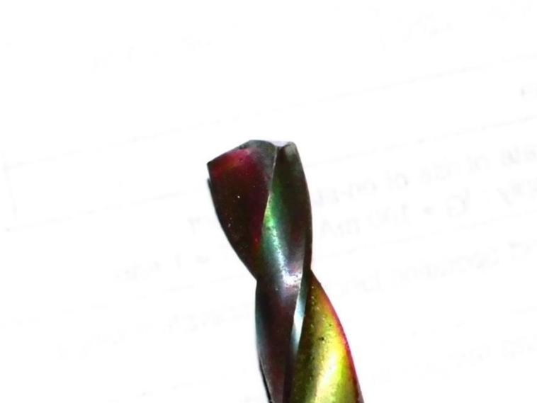
Da die Schweißpunkte recht hart sind, muss man den Bohrer hinterher sowieso neu schleifen.
