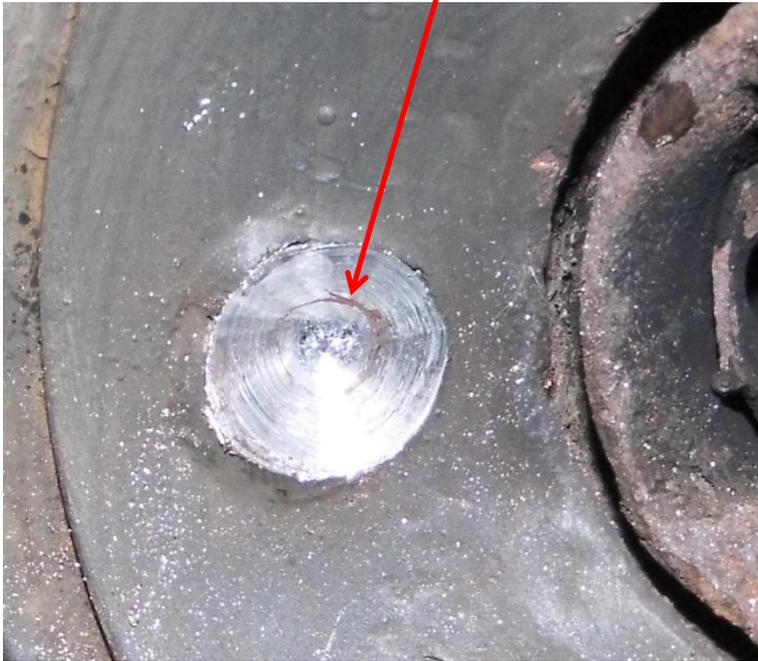
Leider heißt das noch nicht, dass sich die Abdeckung jetzt entfernen lässt – die Schweißverbindungen müssen mit dem Dremel und einem (mehreren) Schleifstiften ausgeweitet werden.
